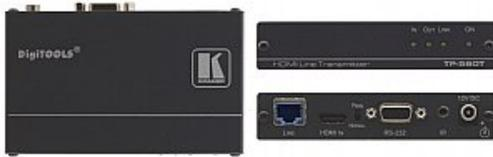
El TP-580T es un transmisiones HDBaseT para señales HDMI 4K@60 (4:2:0), RS-232 bidireccional e IR. Extiende sobre cable de par trenzado CAT, 40 metros una señal HDMI con resolución de hasta 4K@60Hz (4:2:0) 24bpp . El sistema puede alcanzar distancias superiores con resoluciones HD, inferiores a la especificada
